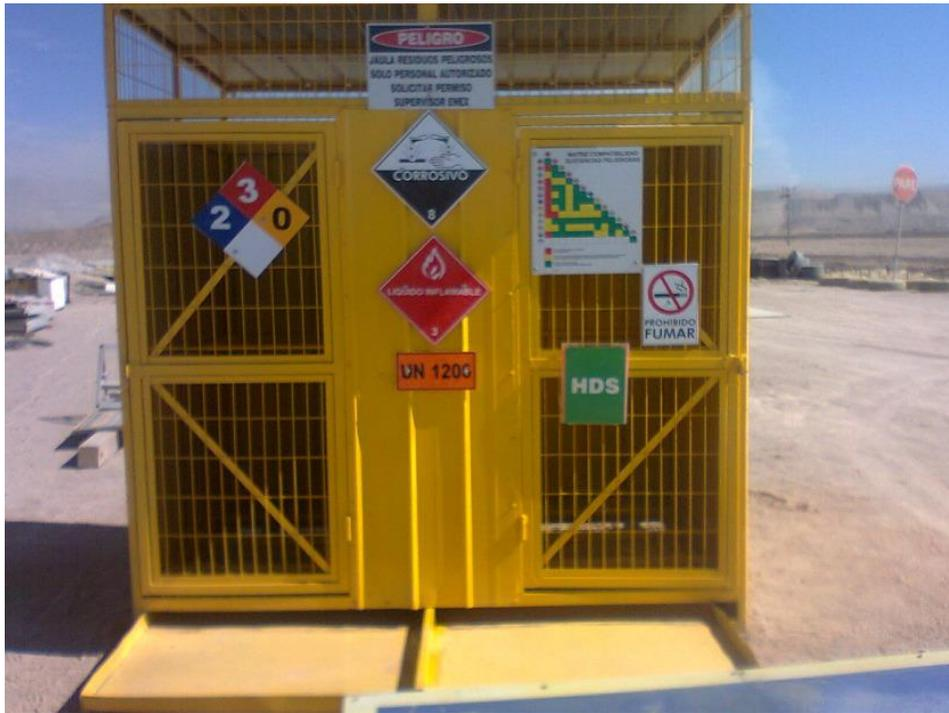
Ilustración 35 Ejemplo de jaula condicionada para almacenar residuos peligrosos o materiales peligrosos
